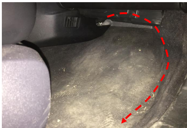
右踏板电机布线：把延伸线通过副驾驶室脚下的海绵隐藏。(虚线)
