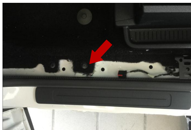
拆内饰件 迎宾踏板已拆卸,方便后续穿电机线用(箭头);
