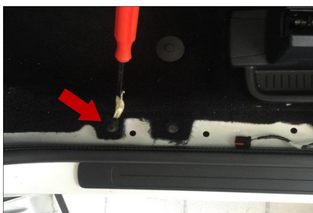
踏板穿线孔 掀开迎宾踏板后,拆下此处卡扣(箭头) 提示:踏板穿线孔左右两边一致。
